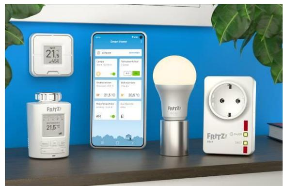
**FRITZ!DECT 301 und 302:** Die intelligenten Heizkörperregler FRITZ!DECT 301 und 302 steuern im Zusammenspiel mit einer FRITZ!Box automatisch und präzise die Raumtemperatur. Beim Design beider Geräte wurde ein E-Paper-Display verwendet, das gut lesbar und energieeffizient ist. Beim FRITZ!DECT 302 wurde das Energiemanagement für eine längere Batterielaufzeit überarbeitet. Gehäusedesign und Bedienung orientieren sich außerdem am Mehrfachtaster FRITZ!DECT 440.
